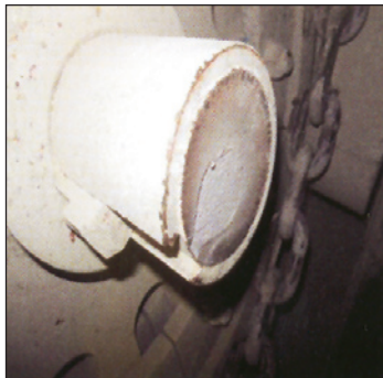
شکل ۱۳: شکستگی یک محور در بالای زنجیری آهک در اثر خستگی فلز
