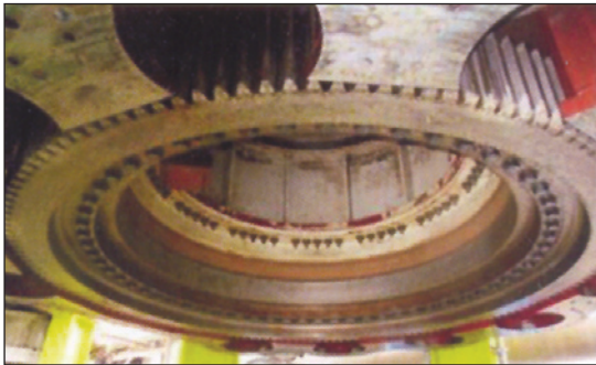
شکل ۱۰a: چرخ‌دنده بزرگ پرس نقاله عمودی با پایه برای گیربکس خورشیدی
