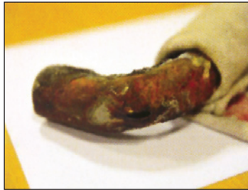
شکل ۱۲: ترک خوردگی در سوپرهیتر کوره بخار
