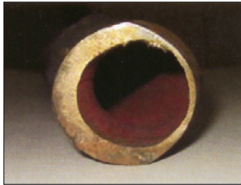
شکل ۱۲: ترک خوردگی در سوپرهیتر کوره بخار
