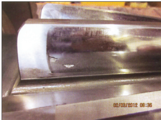
شکل ۱۴: KWL گیربکس پرس تفاله - محور چرخ‌دنده بدون محاسبات RIKOR
