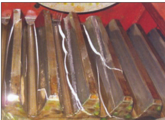
شکل ۱۰b: شکستگی چرخ‌دنده بزرگ پرس نقاله عمودی
